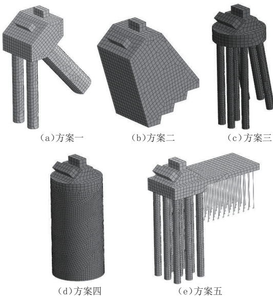
图8 5种基础结构的三维有限元模型图
