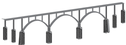
图5 桥梁 MIDAS Civil 三维有限元模型图
