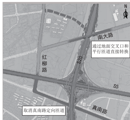
图10 外环普陀段抬升后真大路-南大路节点方案示意
