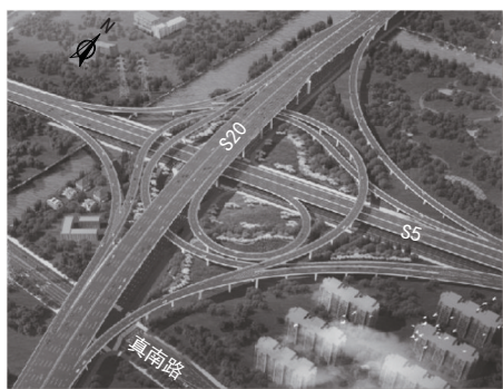
图8 外环普陀段抬升后S20-S5立交方案示意
