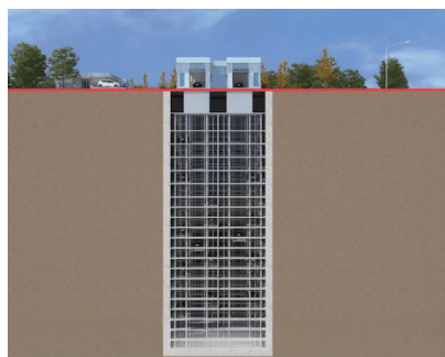
图5 深层停车库剖面示意图
