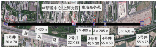
图3 硬X射线工程线路图(单位:m)
