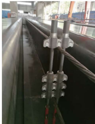
图 6 分体组合式弯起压锚具
