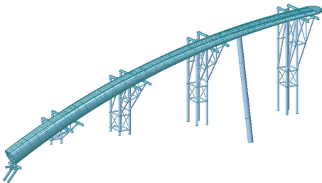
图4 飞翼安装悬臂支架计算有限元模型
