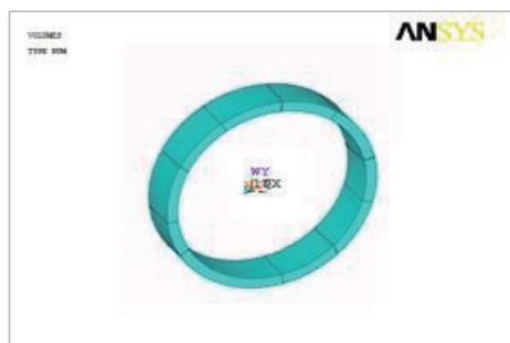
图6 盾构管片有限元模型
