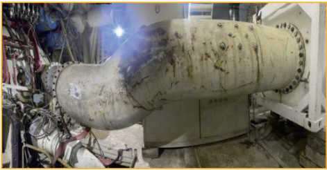
图 4 中心锥与泥水仓、穿梭仓等连接关系图
