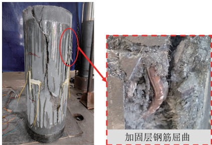
图4 UC试件破坏模式
