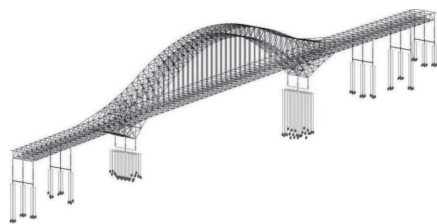
图3 明珠湾大桥有限元模型
