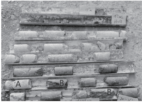
图5 可能存在溶洞的芯样图
