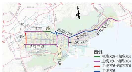
图3 快速路网复合通道及设计速度分布图
