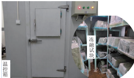
图4 冻融腐蚀试件图
