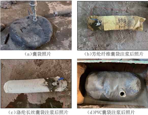
图4 不同材质囊袋试验结果比对
