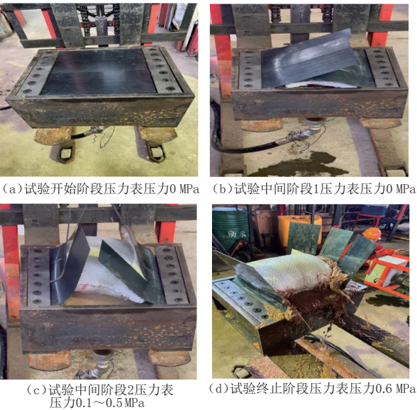
图7 65Mn 弹簧钢板保护的囊袋注浆打开试验过程照片
