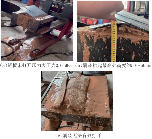
图8 Q235B 钢板保护的囊袋注浆打开试验过程照片
