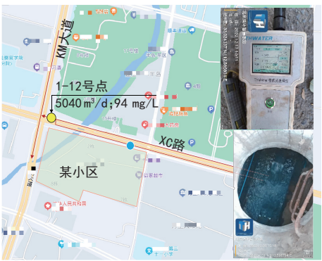
图 10 1-12 号点位污水走向与现场排查结果
