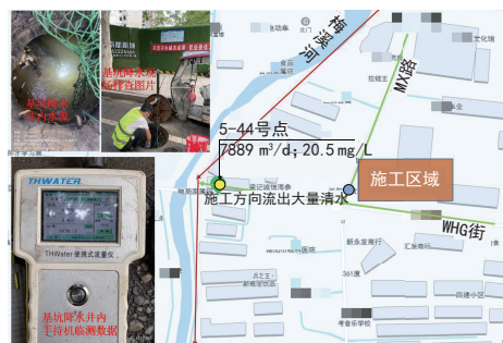
图 8 5-44 号点位污水走向与现场排查结果
