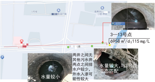
图6 3-13号点位污水走向与现场排查结果
