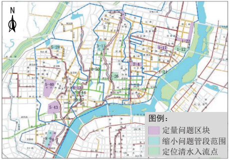
图4 旱天外水入渗严重区域手持机现场临测调查结果分类
