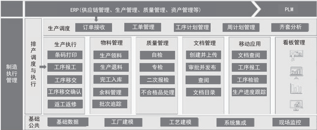
图3 MES系统架构设计
