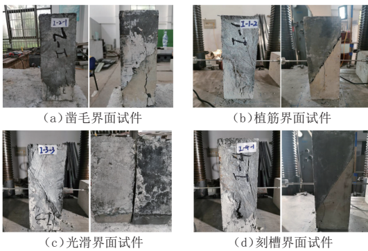
图 5 斜剪试件破坏现象
