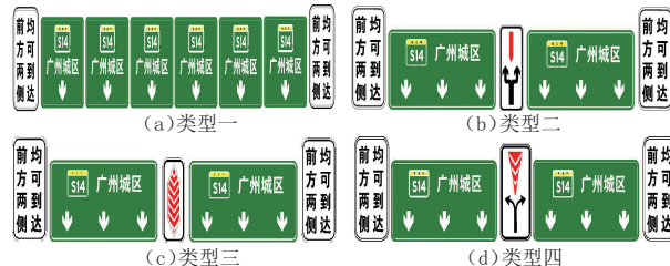
图2 旦架哨隧道段同向分离确认标志类型示意图
