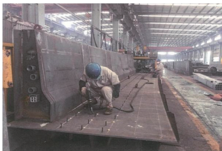
图3 构件装配式制作
