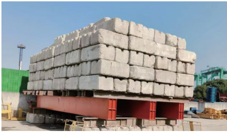
图4 静钻根植桩静载试验现场
