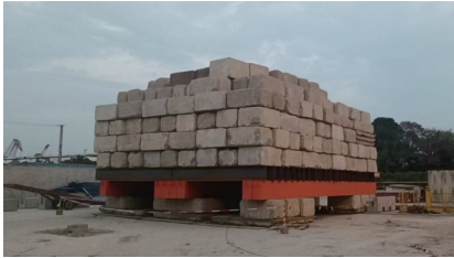
图7 搅拌植入桩端后注浆管桩静载试验现场
