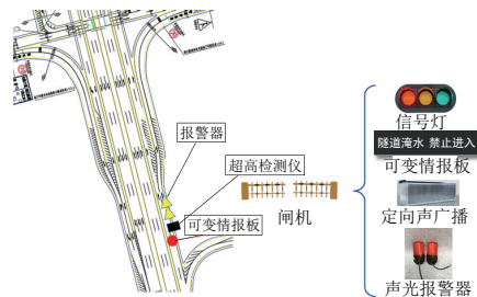
图5 地下环路入口超高超限智能监测和联动管控图
