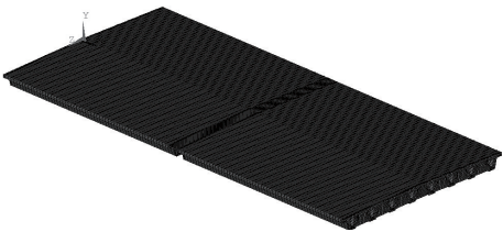
图 1 简支梁有限元模型
