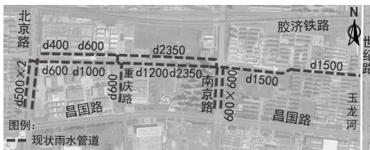
图4 王舍路(北京路—世纪路)现状雨水管道
