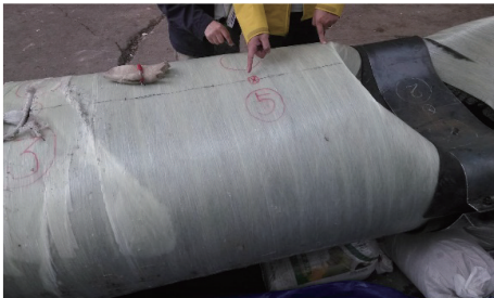
图 9 冲击结果(钢板抱箍加强接头)
