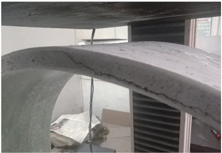
图4 上接触面开裂(径向变形24 mm)
