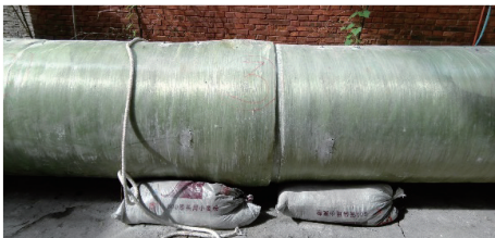
图 11 冲击结果(加强承插式接头)
