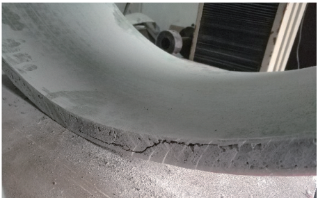
图3 下接触面开裂(径向变形24 mm)
