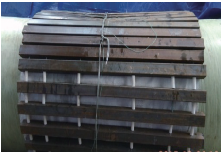
图 10 冲击结果(钢管抱箍加强接头)
