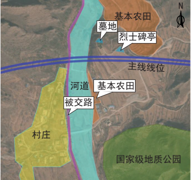
图 5 YY 立交布置控制因素分析图(单位:m)
