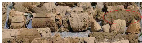
图3 典型钻孔ZK10内12 m附近含水量渐变岩心照片
