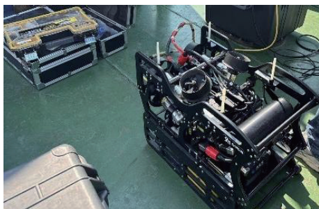
图10 水下机器人携带双频识别声呐
