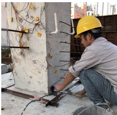
图2 桥墩灌浆套筒连接试验
