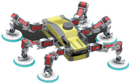
图 1 高空病害勘测及作业机器人结构图
