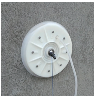
图3 智能爬壁机器人吸盘结构
