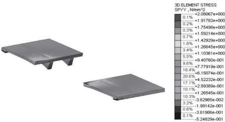
图11 核心箱梁体内束效应扩散至挑臂情况(单位:MPa)
