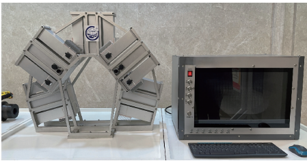
图2 城轨隧道智能检测装备实物图
