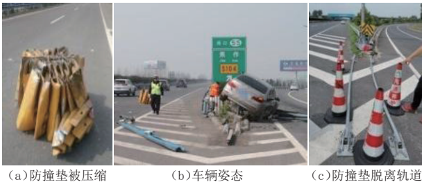
图 2 防撞垫碰撞后被压扁、甚至脱离的事故照片
