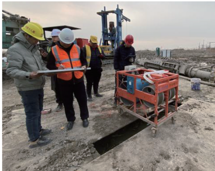
图9 盘腔尺寸超声成孔检测现场照
