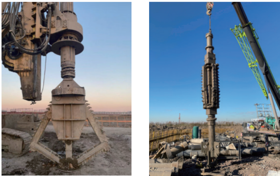
图6 扩孔钻头机具
