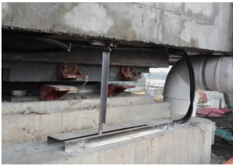
图 4 光纤光栅位移传感器安装图
