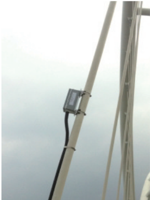
图 5 振动式索力传感器安装照片
