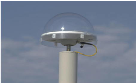
图 3 GNSS 测站实景图
