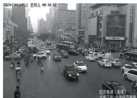
图3 交叉口过大所造成的交通运行混乱实景照
