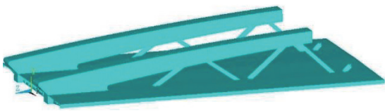
图8 梁端节点精细化模型图
