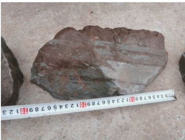
图 36 螺旋输送机排出的砂岩
