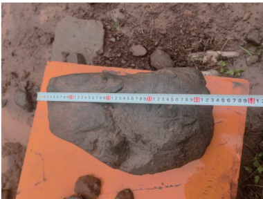
图 35 螺旋输送机排出的泥岩
