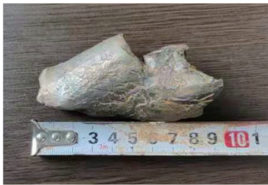
图39 螺旋输送机排出的异物
