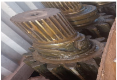
图45 损坏的小齿轮轴
