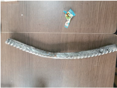
图 37 螺旋输送机排出的钢筋
