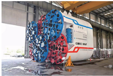
图11 “掘进号”矩形顶管机工厂组装
