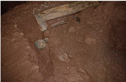
图 28 仓内刀盘结饼照片
