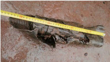
图 38 开仓检查发现地质钻头图
