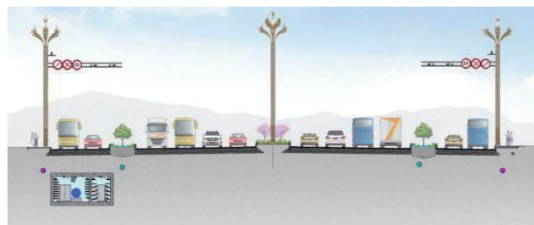
图2 科学大道九龙坡段综合管廊布置图
