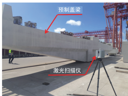
图1 三维激光扫描桥梁预制构件
