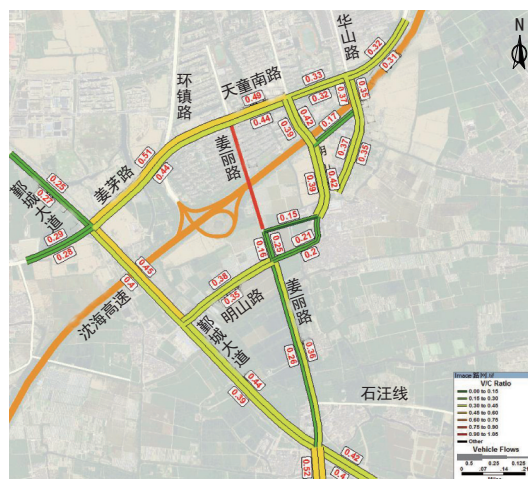
图5 分流交通量叠加前后的路段饱和度示意图
