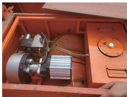
图6 新型伺服支撑头部构造图
