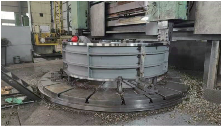
图3 直径3 400 mm 叶轮室加工图
