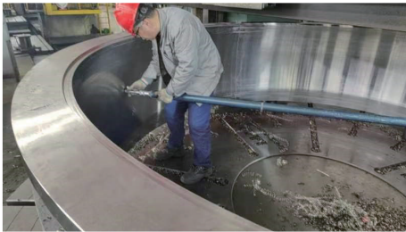
图4 直径3 400 mm 叶轮室尺寸测量图
