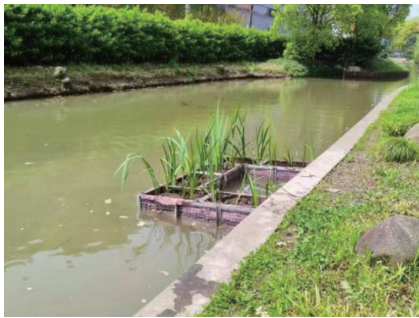
图9 点源净化装置
