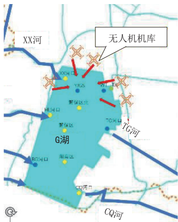
图3 G湖沿岸无人机机库部署方案
