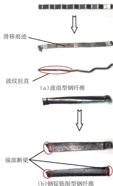
图7 钢纤维破坏模式
