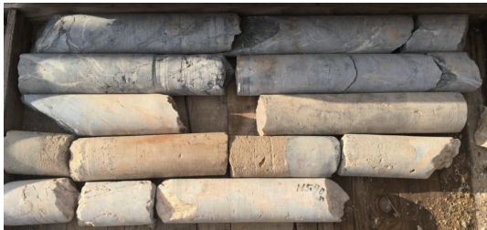
图4 15-1 桩注浆接缝完整
