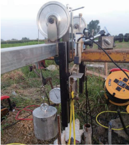
图3 自平衡桩基试验法位移传感器
