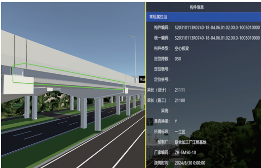
图5 模型构件集成编码及属性
