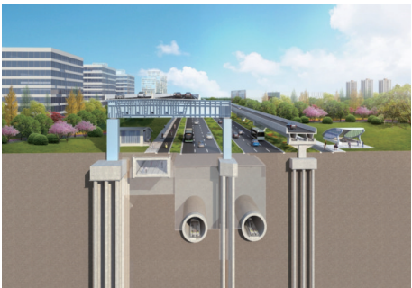
图 3 桩基与地铁分布简图
