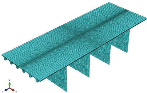
图 2 钢桥面铺装有限元模型
